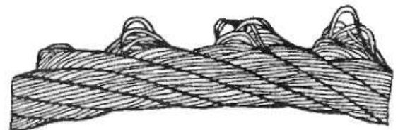
Рис. 10.5. Видавлювання дротів сталок: a – в одній сталці; б – у декількох сталках
